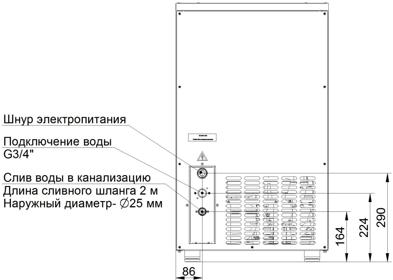
Рис. 4 Схема подключения льдогенератора
